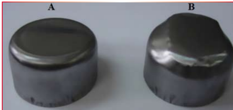
Fig. 10 – (a) Estrutura tipo sanduíche de chapas sem espuma metálica; (b) Estrutura metálica com espuma metálica.
