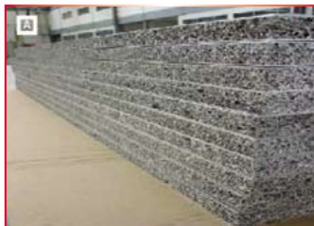
Fig. 4 – Estruturas do tipo sanduíche: (a) Chapas com estrutura tipo sanduíche simples (ALUlight); (b) Estruturas tipo sanduíche complexas (Metcomb Nanostructures).
