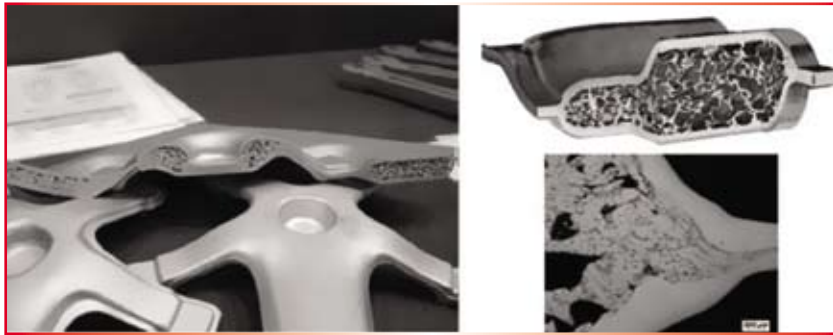
Fig. 6 – Estruturas tipo sanduíche aplicadas à conformação de chapas (15)
